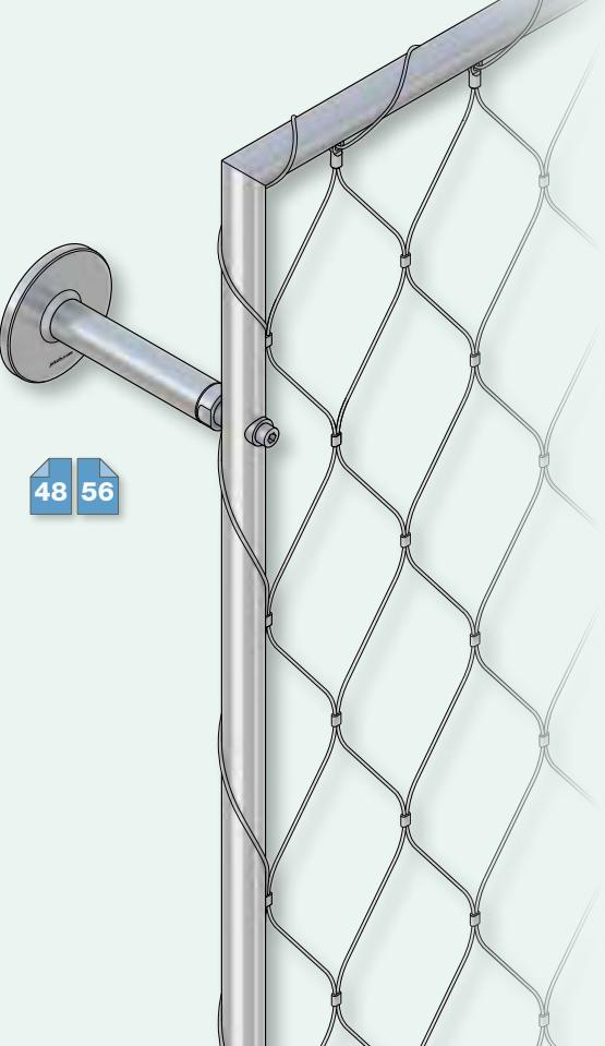
■ Belastungen auf die Befestigungspunkte eines Rankgerüsts
